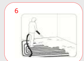
6 Verser une couche de ciment auto-nivellant
