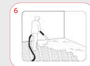
Verser le ciment auto-nivellant
