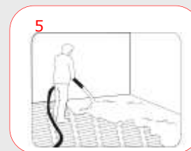
5 Verser sur la trame une couche de ciment auto-nivellant
