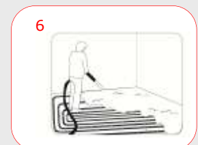
6 Verser une couche de ciment auto-nivellant
